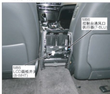
119. 底板控制台后部
